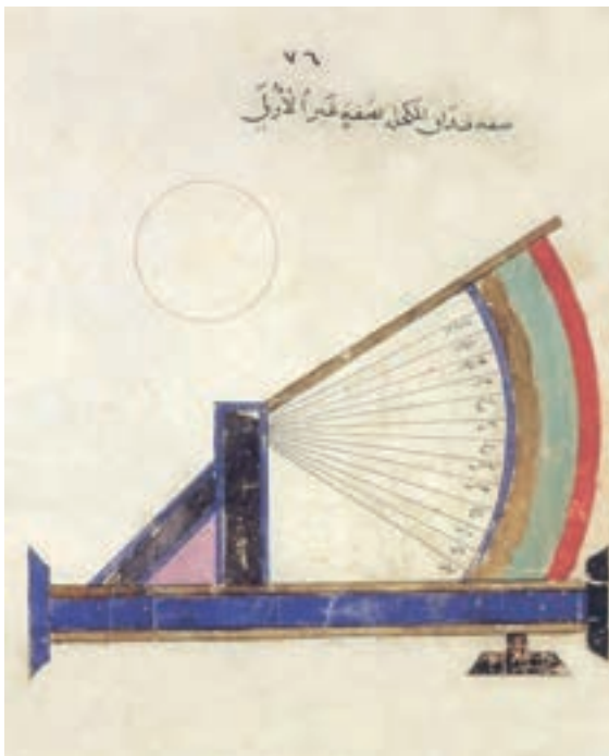
(شكل ١٠) المكحلة أو المدفع كما رسمها أرنبا الزردكاش في مخطوط الأسلحة مع رسم ثلاثة نماذج من غناديق المدافع (حامل المدفع) من النوع المتدرج لمعرفة مدى القذيفة. ومن أعلى مجسم للمدفع معروض في متحف معهد تاريخ العلوم العربية والإسلامية بفرانكفورت.
