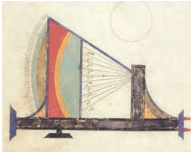
(شكل ١٠) المكحلة أو المدفع كما رسمها أرنبا الزردكاش في مخطوط الأسلحة مع رسم ثلاثة نماذج من غناديق المدافع (حامل المدفع) من النوع المتدرج لمعرفة مدى القذيفة. ومن أعلى مجسم للمدفع معروض في متحف معهد تاريخ العلوم العربية والإسلامية بفرانكفورت.
